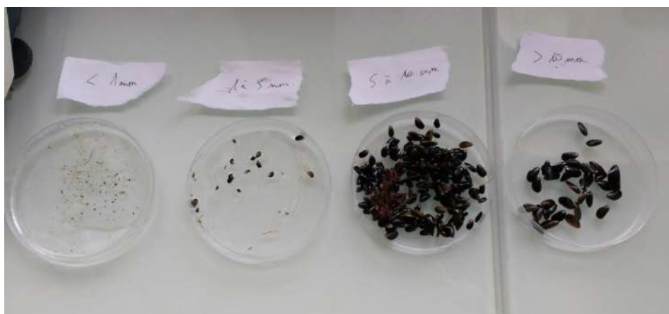
Figure 10 : Tri des moules selon leur taille après leur passage dans plusieurs tamis.
