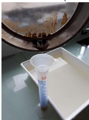
Figure 7 : Récupération du refus du tamis de 40 µm dans une éprouvette graduée de 100 ml.
