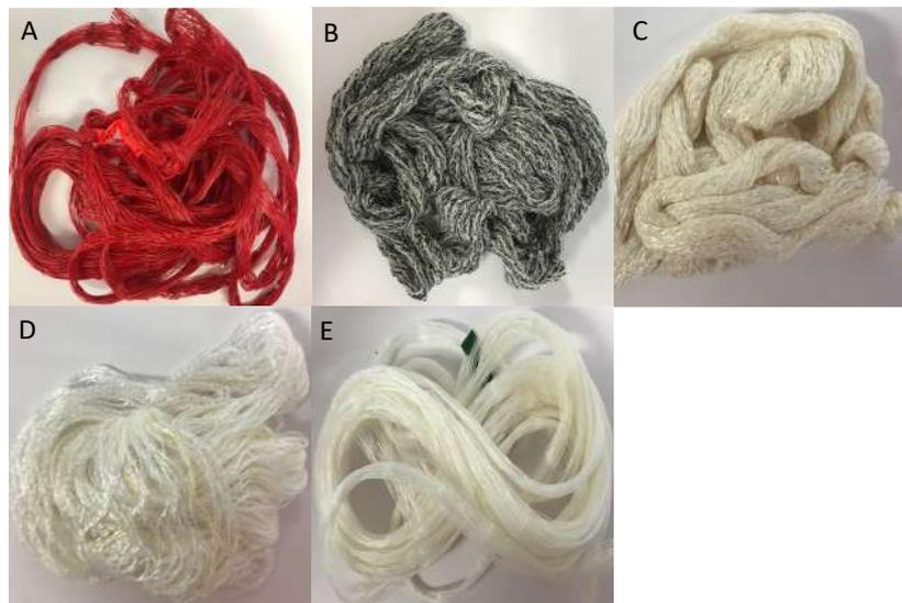
**Figure 1 :** Échantillons réceptionnés correspondant aux différents types de filet A. filet de catinage extrudé conventionnel INTERMAS (Cat-ex-conv), B. Boudin de naissains tricoté coton + PP (Boud-Tri-Conv), C. Boudin de naissains tricoté PLA + PP (Boud-tri-Bio), D. filet de catinage tricoté PLA (Cat-Tri-bio), E. filet de catinage Extrudé SEA212 de Seabird (Cat-ex-bio),
