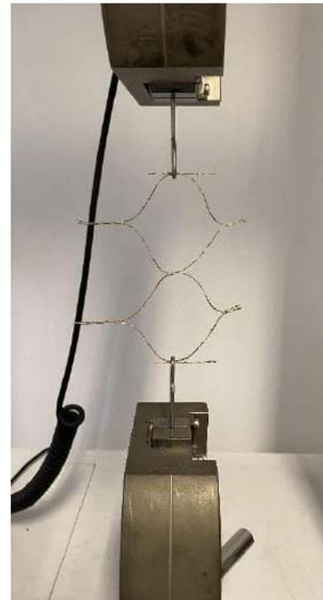
FIGURE 27 : MACHINE POUR LES ESSAIS DE TRACTION
