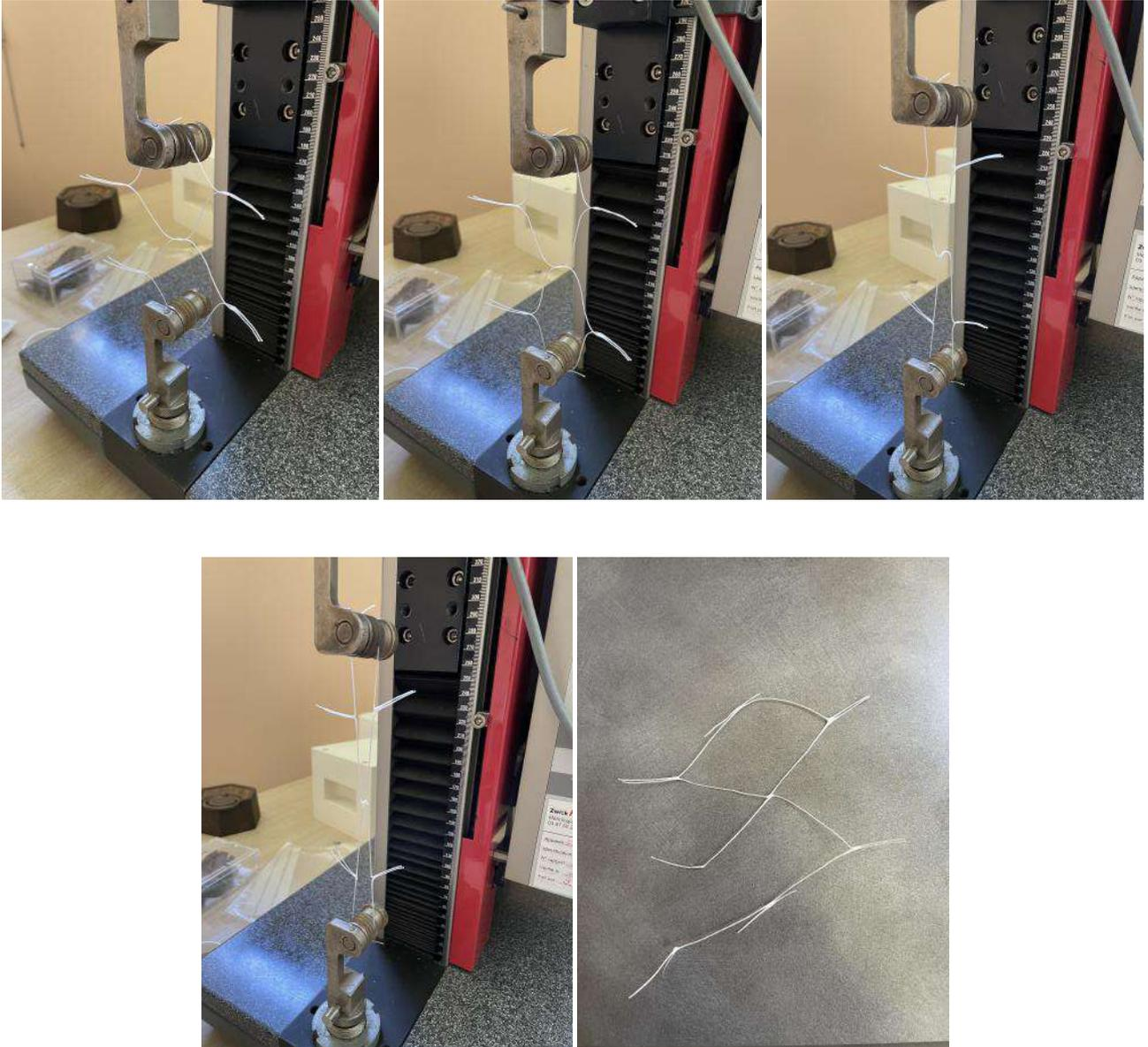
FIGURE 10 – Placement du filet dans la machine de traction et déroulement de l'essai jusqu'à rupture de l'échantillon
