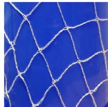
FIGURE 5 : FILET DE CATINAGE TRICOTE (PLA)
