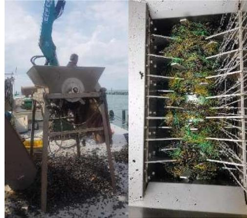
FIGURE 11 : DEGRAPPEUR A DENTS ; VUE EXTERIEURE ; VUE INTERIEURE
