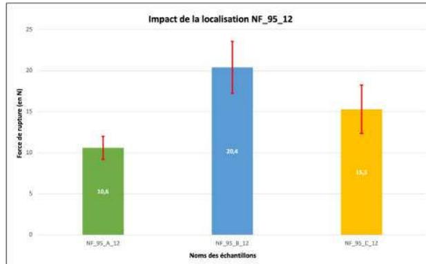
FIGURE 21 – Impact de la localisation sur la force de rupture de l’échantillon NF\_95\_12
