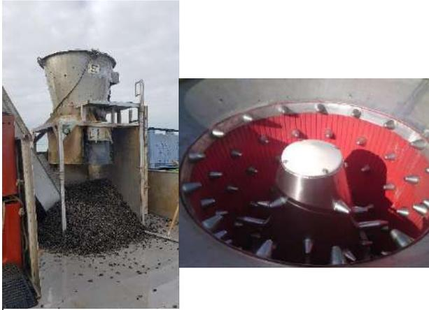
FIGURE 12 : DEGRAPPEUR CONIQUE ; VUE EXTERIEURE ; VUE INTERIEURE
